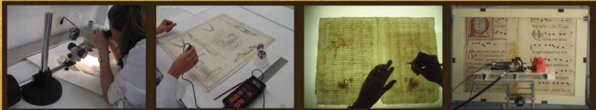
Prueba de solubilidad de tintas. Observando los efectos de una microgota de agua con lupa binocular.
