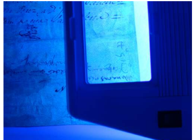
Análisis de la grafía con luz ultravioleta. Permite desvelar tintas desvanecidas.
