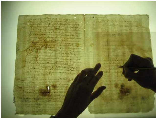
Recogida de datos de la filigrana del papel con luz transmitida. Permite identificar territorial y cronológicamente el soporte
