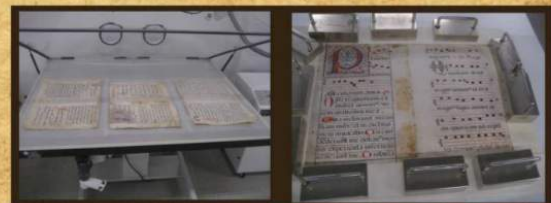
Estabilización del pergamino en cámara de humectación. Alisado del pergamino por tensión perimetral.
